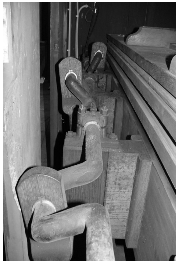
Drehmechanik zur manuellen Betätigung des Doppelfaltenbalges
